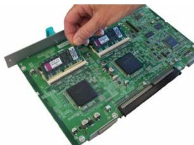
6. Drücken Sie gegen das Modul, bis es hörbar einrastet und die weißen Klammern des Steckplatzes das SO-DIMM-Modul umschließen. Achten Sie darauf, dass sich die Kerbe am SO-DIMM-Modul beim Einsetzen auf der linken Seite befindet. Falls sich die Kerbe nicht an dieser Stelle befindet, lässt sich das SO-DIMM-Modul nicht ordnungsgemäß einsetzen.
