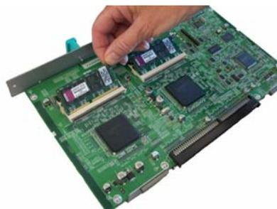
6. Presione el módulo hasta que haga "clic" en su posición y las pestañas blancas del conector de módulos se ajusten alrededor del módulo SODIMM. Asegúrese de que la muesca del módulo SODIMM quede del lado izquierdo cuando inserte el módulo SODIMM. Si la muesca no se encuentra en esa posición, el módulo SODIMM no encajará correctamente.
