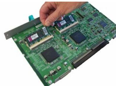
6. Empurre o módulo até ele encaixar e clicar e feche as lingüetas brancas no conector do módulo ao redor do módulo SODIMM. Verifique se a reentrância no módulo SODIMM está voltada para o lado esquerdo ao inserir o módulo SODIMM. Se a reentrância não estiver nessa posição, o módulo SODIMM não será inserido corretamente.
