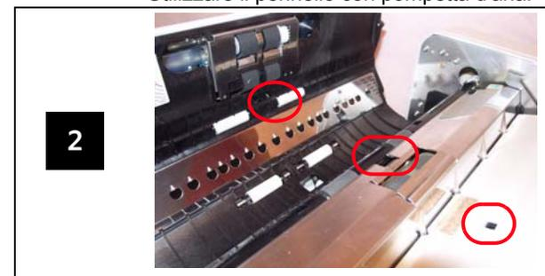
Sensore carta, sensore in attesa e rilevatore di alimentazione doppia.
