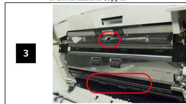
Sensore di fine, sensori di disallineamento e sensore di inizio.
