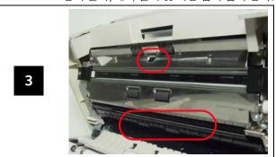
종료 센서, 기울기 센서 및 시작 센서.
