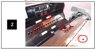
종이 센서, 대기 센서 및 이중 급지 감지 장치.
