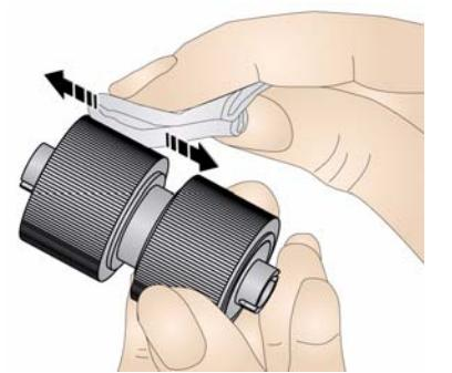
Frottez les anneaux du rouleau par un mouvement de va-et-vient avec un tampon de nettoyage des rouleaux, puis remettez le rouleau en place.
