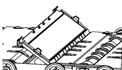
Réinsérez le guide de numérisation dans le scanner.
