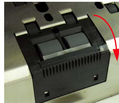
Tirez vers l'avant le capot du rouleau de séparation et retirez le rouleau de séparation. Frottez les anneaux par un mouvement de va-et-vient avec un tampon de nettoyage des rouleaux, puis remettez le rouleau de séparation en place.
