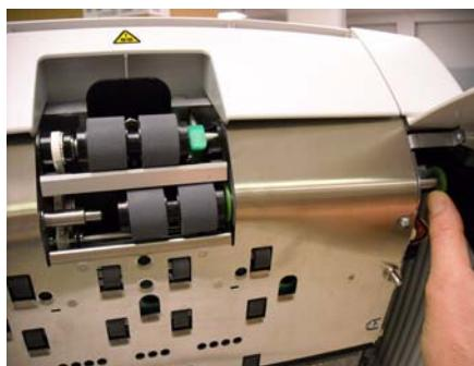
Retirez le rouleau d' entraînement en poussant le rouleau vers la droite. Maintenez le rouleau d' entraînement en place puis faites-le glisser hors de son arbre. Remettez doucement l' arbre-du-rouleau d' entraînement dans sa position d' origine.
