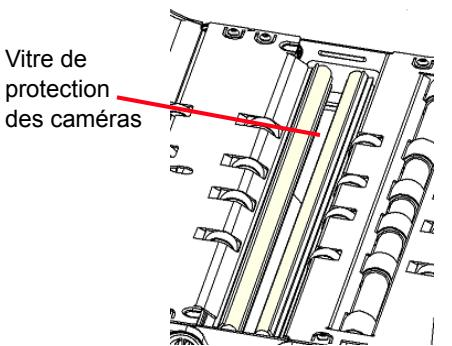
Repérez la vitre de protection des caméras entre les voyants et en dessous les lampes. Nettoyez-la à l'aide d'un tampon sec. **N'utilisez pas de dissolvant lors du nettoyage de la vitre de protection des caméras.**
