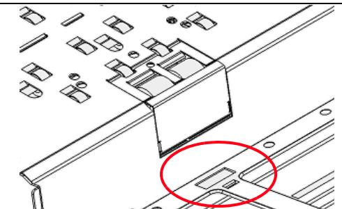
Utilisez le pinceau soufflant pour nettoyer les 7 capteurs. Le capteur d'alimentation est indiqué ci-dessus.
