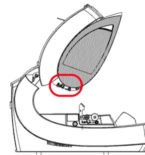
Nettoyez le capteur de sortie qui se trouve sur le circuit d' entraînement, à l' arrière du scanner.
