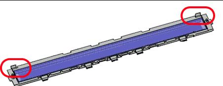
Desserrez les attaches de fixation du guide de numérisation et retirez ce dernier du scanner. Nettoyez les deux côtés avec un chiffon antistatique. Essuyez ensuite le guide à l'aide d'un chiffon non pelucheux.
