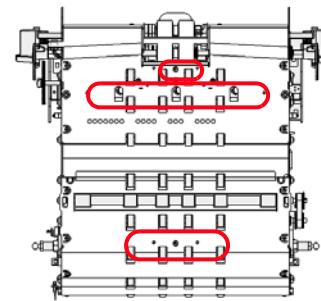
Nettoyez les capteurs d'intervalle, les capteurs d'entrée de page et les capteurs de passage direct.
