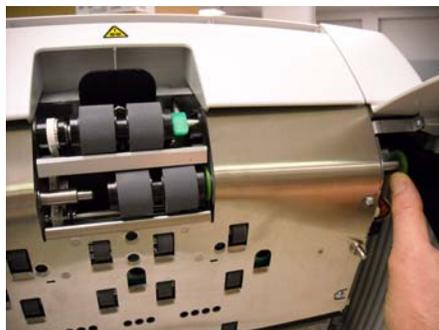
ローラを右に押し、ドライブローラを取り外します。ドライブローラを固定してシャフトから取り外します。ドライブローラシャフトを元の位置にそと戻します。
