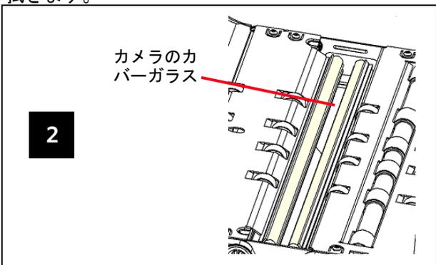
LED ランプの間にあるカメラのガラスカバーを特定し、乾燥した綿棒で汚れを落とします。カメラガラスの清掃には溶剤を使わないでください。
