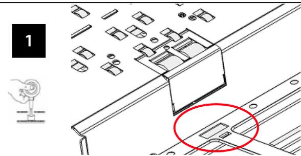
送風器ブラシを使用して、7箇所すべてのセンサーをクリーニングします。給紙センサは上図に示されています。
