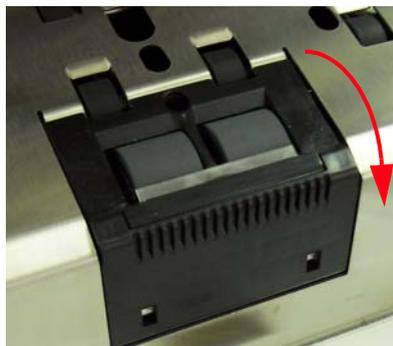
セパレーションローラのドアを手前に引き、セパレーションローラを取り外します。ローラクリーニングパッドを使ってタイヤを端から端まで拭き、セパレーションローラを取り付けます。
