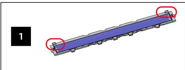
イメージングガイドの留め具を外し、スキャナーから取り外します。静電クリーニングクロスでガイドの両側を拭いてから、糸くずの出ない布でガイドを拭きます。
