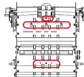
次に、溝センサ、ページエントリセンサ、パススルーセンサをクリーニングします。
