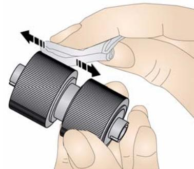
ローラクリーニングパッドを使ってローラタイヤを端から端まで拭き、ローラを取り付けます。次にピックローラを取り付けます。
