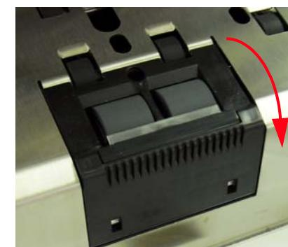
분리 롤러 도어를 앞으로 당겨 분리 롤러를 제거합니다. 롤러 청소용 패드를 사용하여 롤러 타이어를 좌우 방향으로 닦은 후 분리 롤러를 다시 설치합니다.
