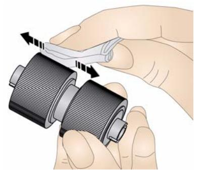
롤러 청소용 패드를 사용하여 롤러 타이어를 좌우 방향으로 닦은 후 롤러를 다시 설치합니다. 완료되면 픽 롤러를 다시 설치합니다.
