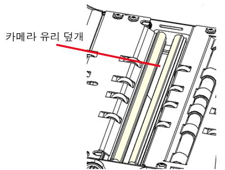
LED 램프 하단에 있는 카메라 유리 덮개를 찾습니다. 마른 탈지면으로 유리 덮개를 청소합니다. 카메라 유리를 청소할 때 세제를 사용하지 마십시오.
