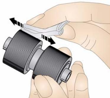
用滚筒清洁垫来回擦拭滚筒滚轮，然后重新装上滚筒。完成时重新装上取纸滚筒。
