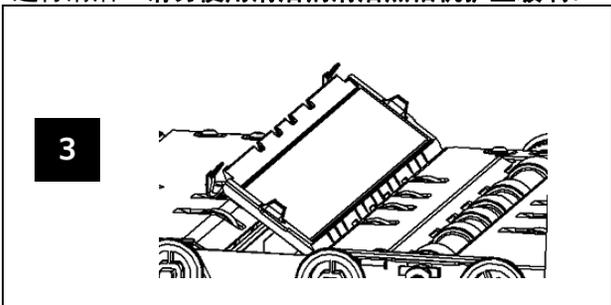
重新将成像导轨插入扫描仪。
