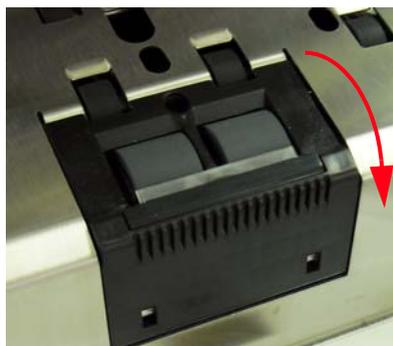
将分纸滚筒盖板向前拉，取下分纸滚筒。用滚筒清洁垫来回擦拭滚轮，然后重新装上分纸滚筒。
