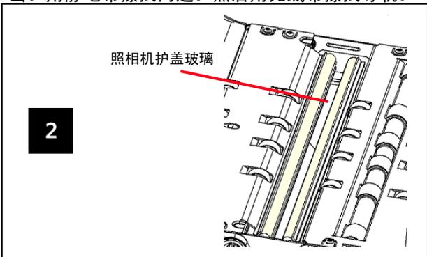
从两个 LED 灯之间的下方找到护盖玻璃。用干拭子进行清洁。请勿使用清洁剂清洁照相机护盖玻璃。
