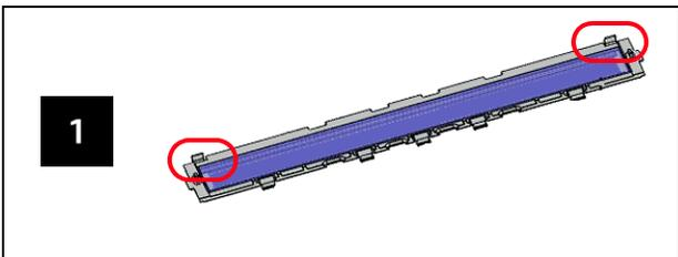
释放成像导轨上的紧固夹，将成像导轨从扫描仪中取出。用静电布擦拭两边。然后用无绒布擦拭导轨。
