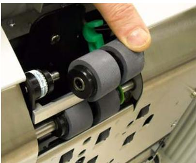
将取纸滚筒向右推，并卸下取纸滚筒。
