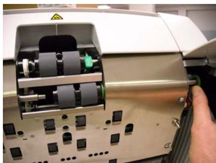
通过将滚筒向右推，卸下驱动器滚筒。将驱动滚筒固定到位并将其滑离滚筒轴。轻轻松开驱动滚筒轴，使其复归原位。
