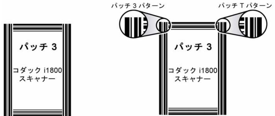
スキャン中にページが傾き、ページの右エッジが最初にカメラを通過した場合、パッチページは Type 3 パッチではなく Type T パッチとして読み取られます。
