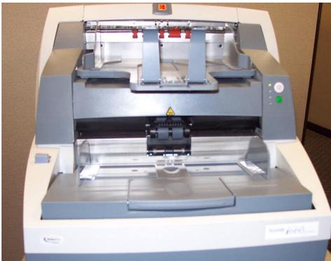
2. Setzen Sie den Einzelblatteinzug auf das Papierhebefach und achten Sie darauf, dass die Aussparungen im Einzelblatteinzug genau auf die Seitenführungen ausgerichtet sind. Schieben Sie den Einzelblatteinzug in die endgültige Position.
