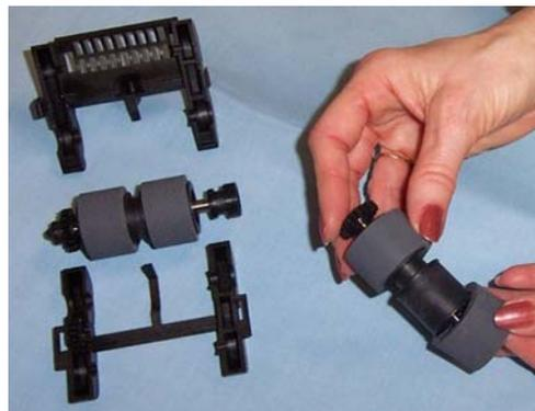
5. Instale las gomas nuevas estirándolas suavemente sobre el ensamblaje.
