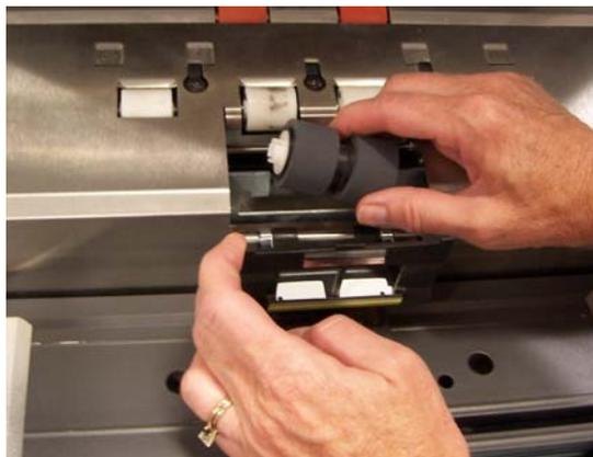
4. Empuje el soporte del rodillo de separación hasta colocarlo en la posición original y cierre el compartimento.
