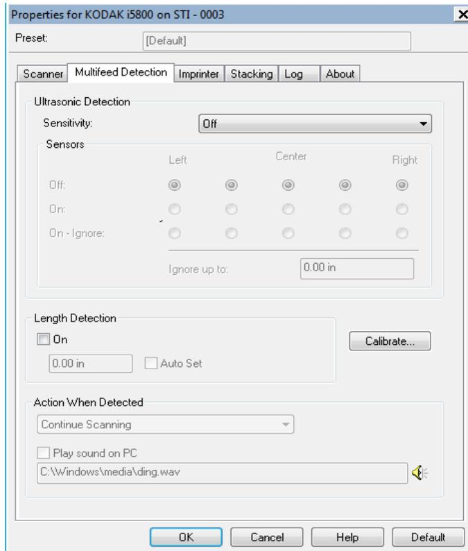
**Détection par ultrasons** : cochez cette case pour activer la détection des doubles.
