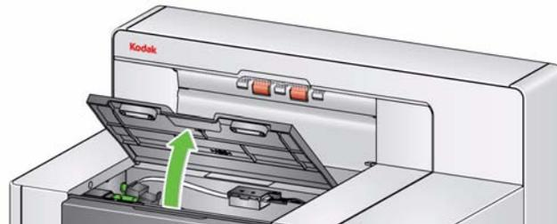
注：出カトレイを取り外さない場合は、出カトレイの前面部を持ち上げてから、プリンタアクセスカバーを高さの調節タブの後ろに来るように持ち上げます。
