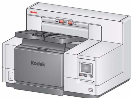
出カトレイを下げる場合は、出カトレイ下の高さ調節タブをゆっくり押してから、出カトレイを前部プリンタアクセスカバーの方に下げます。
