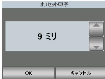
3. 上下矢印を使用して、オフセット印刷の数値を（インチまたはミリメートル単位で）増加または現象させます。スキャンアプリケーションで設定された印字位置から前後して印字されます。例えば、ドキュメントの先端から1インチ / 25 mm から印刷を開始する設定だった場合に、オフセット印刷ポジションを1インチ / 25 mm 増加させると、印刷は先端から2インチ / 50 mm の位置から開始されます。
