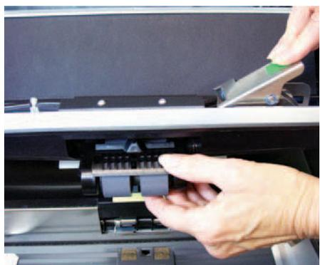
**Modulo di alimentazione:** sostituirlo dopo 4 sostituzioni delle gomme, approssimativamente ogni 2.400.000 scansioni. Installare contemporaneamente un modulo di alimentazione e un rullo separatore nuovi.
