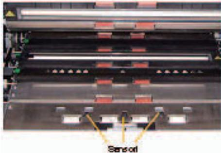
Questi sensori utilizzano onde sonore per stabilire se nel dispositivo di trasporto sono presenti due o più documenti allo stesso tempo. È possibile applicare al sistema di rilevamento di alimentazione multipla una delle seguenti tre impostazioni:
