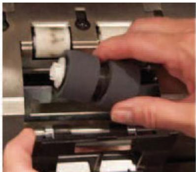
**Rullo separatore:** sostituirlo dopo 4 sostituzioni delle gomme, approssimativamente ogni 2.400.000 scansioni. Installare contemporaneamente un modulo di alimentazione e un rullo separatore nuovi.
