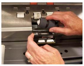
4. Riportare alla posizione normale il supporto del rullo separatore e chiudere il dispositivo pod.
