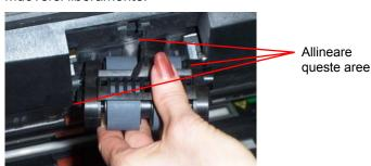
2. Chiudere il dispositivo pod, chiudere il coperchio di accesso della stampante e montare nuovamente il vassoio di uscita.
