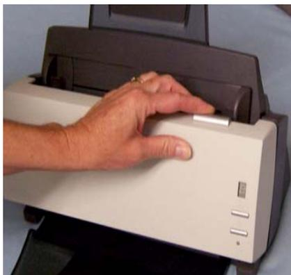
2. Una volta terminate le operazioni di pulizia dei componenti interni o di sostituzione delle parti, chiudere il coperchio dello scanner.
