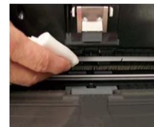
2. Pulire i rulli NFR da un lato all'altro. Ruotare i rulli NFR per pulirne l'intera superficie. Per agevolarne la pulizia, ordinare i bastoncini di cotone per la pulizia dello scanner Kodak i1120.
