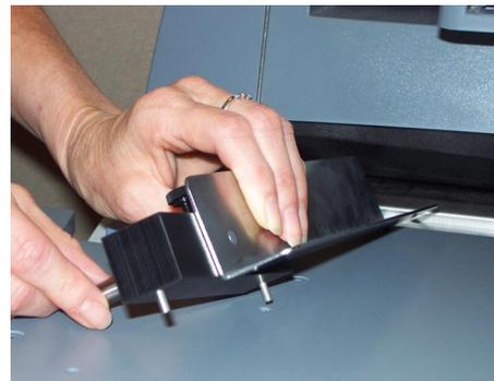
4. Após fixar a guia lateral esquerda, instale a direita da mesma maneira.
