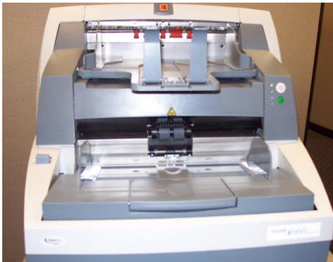
2. Coloque o alimentador sobre a bandeja do elevador. Use as ranhuras do alimentador para alinhá-lo com as guias laterais. Posicione o alimentador manual de modo a encaixá-lo completamente.
