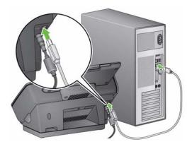
4. 将 USB 电缆连接到位于扫描仪背面的扫描仪 USB 插槽。
