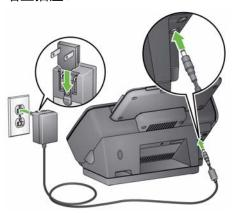
3. 将电源适配器插入扫描仪的电源插槽。
