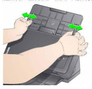
3. 如果必要,可调整输入和输出托盘以满足您的扫描需求。输出托盘可以延长以适应长达 35.56 厘米(14 英寸)的文档。提供了一个终端挡板来适应文档堆叠。根据需要提起该终端挡板以扫描长达 A4(11.7 英寸)的文档。
