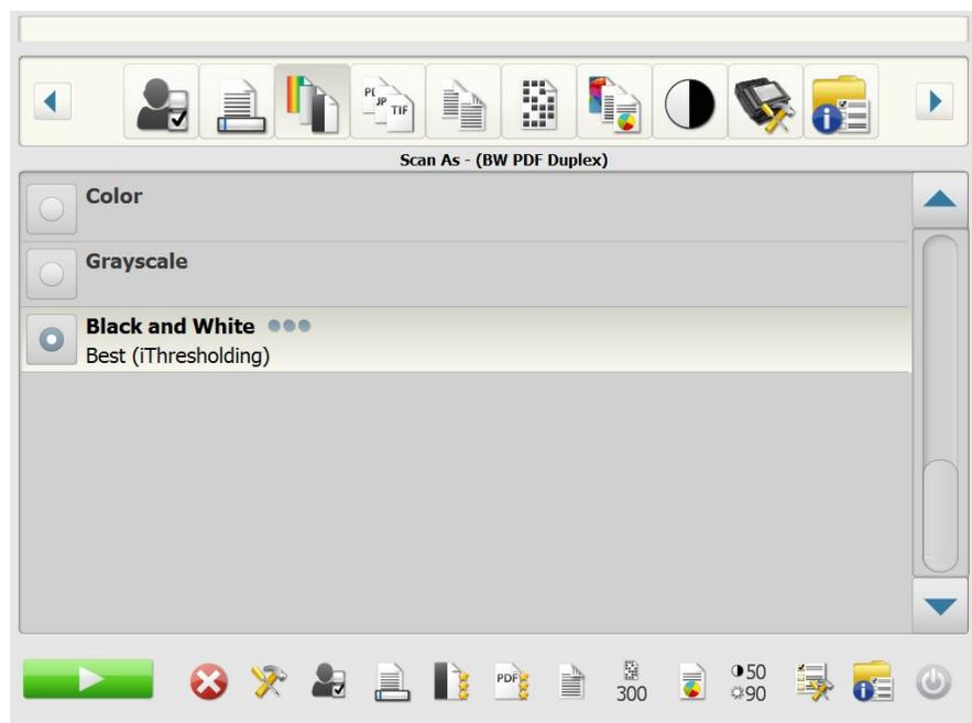
Wenn Sie **Schwarzweiß** auswählen, wird der Bildschirm schwarzweiß angezeigt. Wählen Sie entweder **Optimal (iThresholding)** oder **Normal (ATP)** aus.
