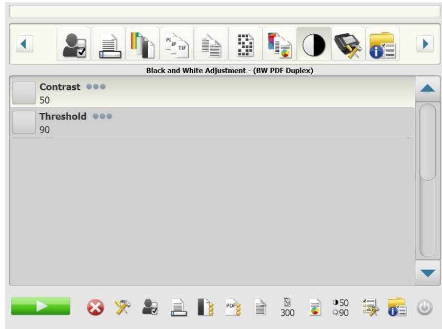
**Kontrast** – Passt den Anteil des Bildvordergrunds an, der beibehalten oder abgeschwächt wird. Die Verringerung dieser Einstellung führt zu einer Rauschreduzierung, allerdings besteht die Wahrscheinlichkeit des Verlusts blassen Textes. Die Erhöhung dieser Einstellung führt dazu, dass blasser Text besser sichtbar ist, aber auch zu einer Rauscherhöhung.
