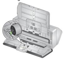
Vuelva a instalar la almohadilla de separación frontal. Para ello, alinee las ranuras con los orificios de la almohadilla de separación frontal y encájela en su lugar.
