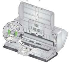
3. Sujete el rodillo de separación y tire de él hacia afuera. Deséchelo.
