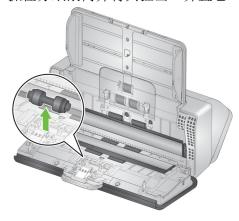
4. 安装新的分纸滚筒,对齐弹片和插槽并将它卡入定位。
