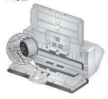
5. 装回预分纸垫片(或安装新的垫片),方法是 对齐插槽和预分纸垫片上的孔,然后将它卡入 定位。
