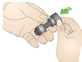
5. Instale o novo rolo de separação alinhando a guia com o compartimento e encaixando-o na posição.
