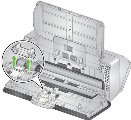
2. Descarte a base de pré-separação usada.
