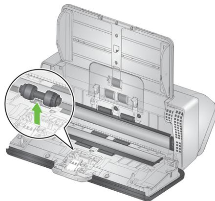
4. Instale o novo rolo de separação alinhando a guia com o compartimento e encaixando-o na posição.
