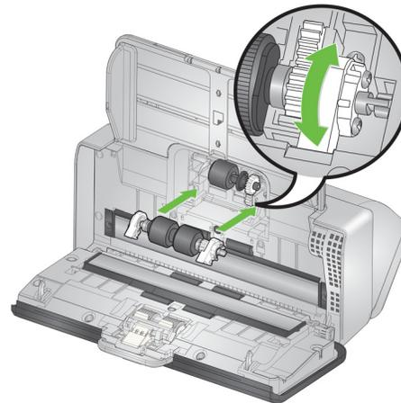
5. Reinstale a tampa do rolete de alimentação posicionando-a em torno do sensor de papel presente, alinhando a borda inferior da tampa com o scanner e empurrando-a para trás até encaixá-la no lugar.
