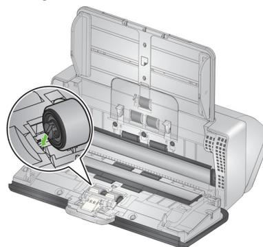
5. Reinstale a base de pré-separação (ou instale uma nova) alinhando os compartimentos com os furos na base de pré-separação e encaixando-a no lugar.
