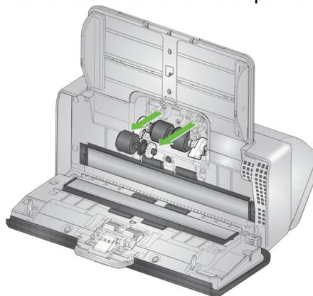
4. Remova o pneu do rolamento de impulso. Segure o pneu, levante-o sobre a flange e retire-o do rolamento.
